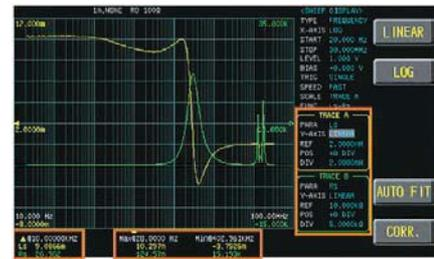
2つの測定パラメータを同時にスイープできます。スイープ種類 (周波数/Vac/Iac)、スイープスケール (LOG/LINEAR)、スイープ速度、内部バイアス付加等の設定もできます。スイープが完了すると自動的に最適な表示が得られ、カーソルによる測定値の読み取りが可能です。前面パネルのUSBポートに装着したUSBメモリにスイープ表示画面と測定値を保存できます。
