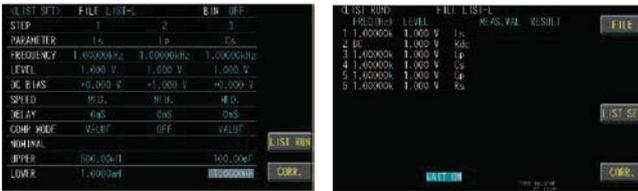
15ステップのリスト測定モードは特定の周波数または電圧における測定値が可能です。各ステップの測定結果は個々に比較/判定ができます。トリガーモードを「AUTO」に設定すると、測定画面に「WAIT ON」と表示され、テストリードの接続状態を検出します。DUTが接続されると、自動的に測定が開始されます。
