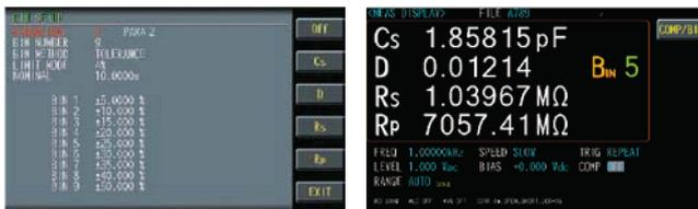
各測定パラメータに対するBIN数は最大9まで設定できます。個々の分類の判定基準はBIN手法 (EQUAL/SEQUENTIAL/TOLERANCE/RANDOM) および判定基準 (絶対値、許容値、許容割合) から選択できます。この分類の結果はハンドラインタフェースを介しても取得できますので、ソーターなどの外部機器に直接接続すれば、すぐに部品の仕分けができます。
