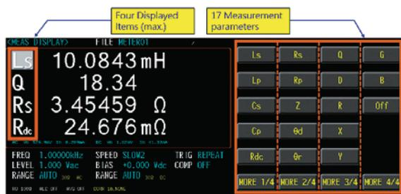
LCR-8200 は、測定パラメータを任意に選択表示が可能です。ユーザーは測定に応じて、17 の測定パラメータから最大 4 つのパラメータを選択可能で、表示順も任意に配置できます。
